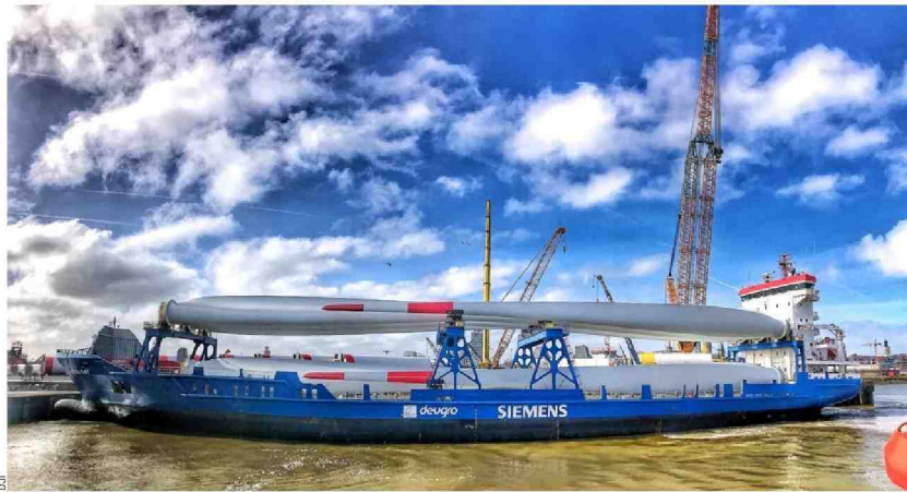
■ De Rotra Mare is speciaal ontworpen voor het efficiënt vervoeren van onderdelen voor windmolens.
