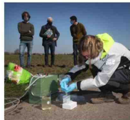
Een onderzoeker pompt grondwater omhoog om de waterkwaliteit te testen. FOTO DICK DEMEY
